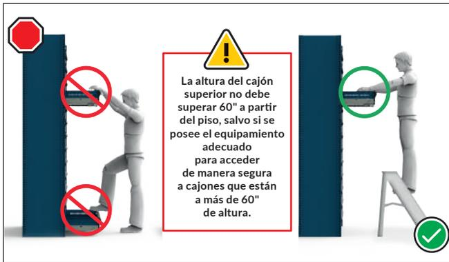
La altura del cajón superior no debe superar 60" a partir del piso, salvo si se posee el equipamiento adecuado para acceder de manera segura a cajones que están a más de 60" de altura.
